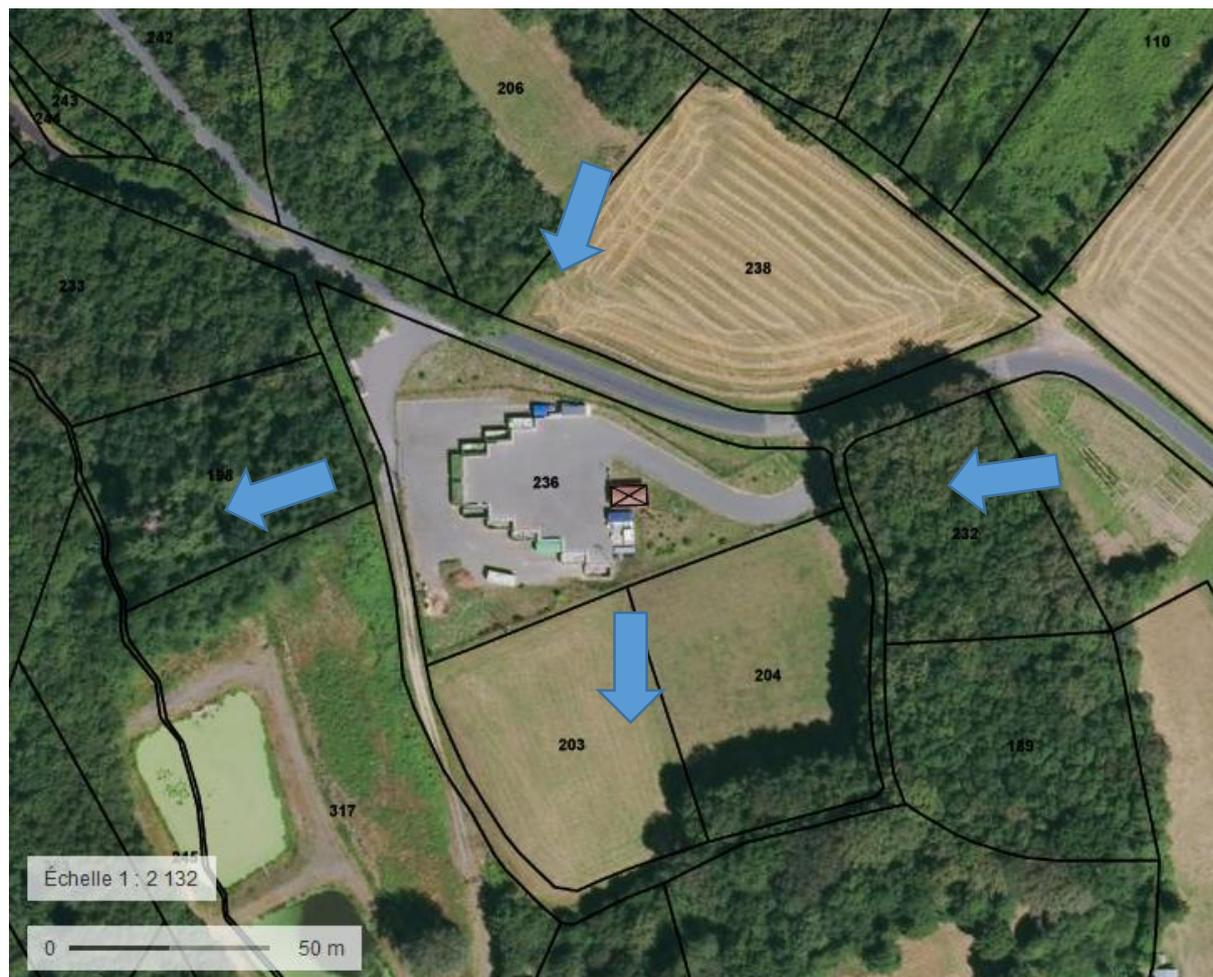
Figure 3 : Sens d'écoulements des eaux pluviales aux abords du site d'implantation de la déchèterie
